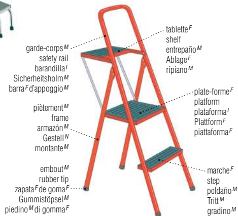
marchepied M platform ladder escalera F de plataforma F Trittleiter F scala F con piattaforma F
